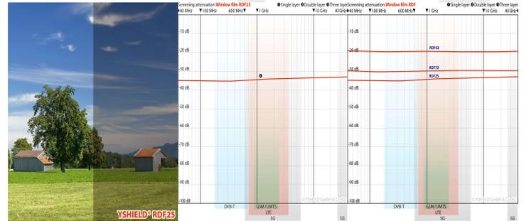
Film anti ondes RDF25 pour vitrages et fenêtres. Une atténuation de 34 dB et une transmission de la lumière de 25%. Idéal pour se protéger de l'influence d'une antenne-relais dans son voisinage, **utilisable même sur fenêtres déjà anti-chaueur, par l'extérieur, pour renforcer leur atténuation anti-ondes.** Les fenêtres sont souvent des points d'entrée privilégiés pour les ondes hautes fréquences.
