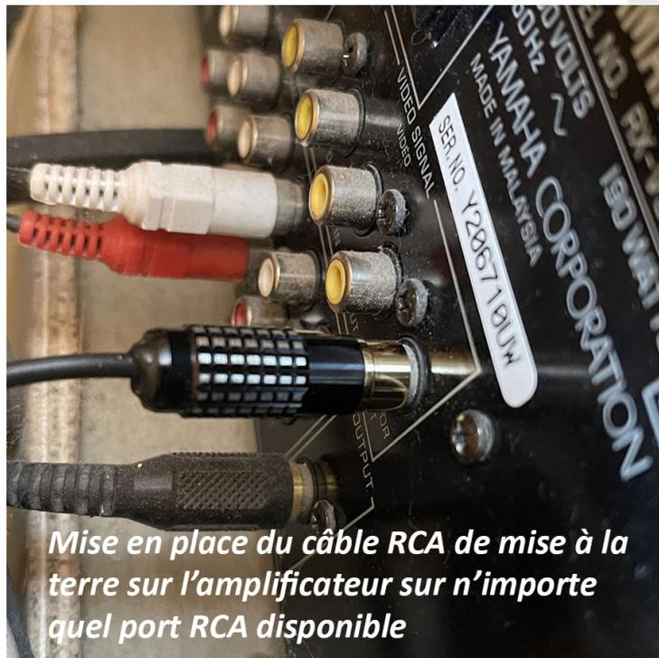
*Mise en place du câble RCA de mise à la terre sur l'amplificateur sur n'importe quel port RCA disponible*
