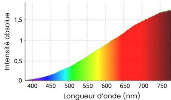
Spectre ampoule LED à filament
