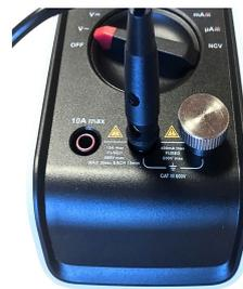
Électrode de pouce à fixer sur un multimètre. Elle est utilisée pour la mesure de tension induite du corps en posant simplement le pouce dessus. Utilisation avec un câble de mise à la terre (non fourni) et un multimètre (non fourni également).
