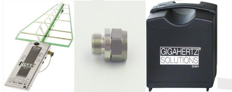
Usage semi-professionnel pour déterminer d'où proviennent les principales sources extérieures par des mesures directionnelles et évaluer la pollution électromagnétique extérieure entrante dans l'habitat. La nouvelle antenne du HF38B (10/2018) démarre à 700 MHz, fréquence des dernières antennes de téléphonie mobile 4G, pour aller plus loin que l'ancienne gamme des produits Gigahertz Solutions.
