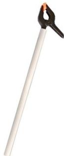
Cette perchette isolante permet de mesurer les champs électriques de basses fréquences sans les perturber pour les appareils de la série ME Gigahertz Solutions jusque ME3840. C'est la solution la plus simple et fonctionnelle pour faire des mesures de qualité en mode "hors potentiel", c'est à dire appareil de mesure non relié à la terre. **Pour la série ME3851A et ME3951A, préférer le kit PM5.**
