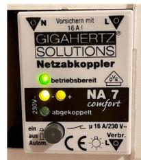
NA7 Comfort, circuit sous tension, consommation d'un appareil en route
