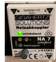
NA7 Comfort, bouton non enfoncé (aus) = Circuit forcé sous tension (bypass), pas de coupure automatique de champ = Ne jamais laisser l'appareil dans cette position sans quoi l'IAC n'a aucun intérêt!
