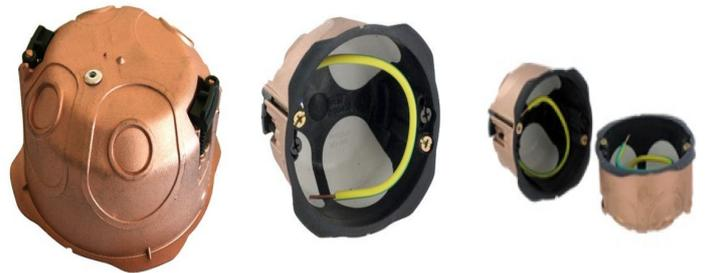
Boîtiers faradisés simples étanches à l'air en 67 x 40 pour cloisons sèches. Complément essentiel aux fils, câbles et gaines blindés pour réaliser une installation électrique biocompatible. Idéal dans pièces sensibles telles que chambres et lieux de repos. Spécialement préconisé en éco-construction et pour les cloisons bois ou plâtre.
