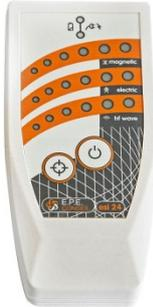
Détecteur d'ondes électromagnétiques toutes fréquences ESI24 : Détecte simultanément les basses et hautes fréquences, ou pour les hyperfréquences seules avec un mode amélioré plus sensible Full HF. Il possède une démodulation sonore des hyperfréquences en mode Full HF permettant de déterminer quelles sont les sources d'ondes détectées et de vérifier les corrections effectuées !
