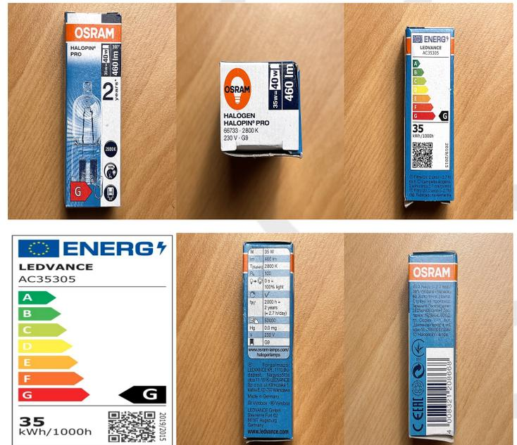
Ampoules halogène de remplacement pour nos spots tressés. G9, 35W (équivalent 40W), caractéristique énergétique cat. G, 2800°K (blanc chaud). 2000 h de fonctionnement, indice de rendu des couleurs Ra100, dimmable.
