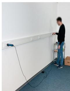
Bien que pas cher, le contrôleur de terre PCE-ECT-50 mesure selon nos tests avec précision la valeur de la prise de terre et contrôle le bon câblage des prises de courant. Il dispose d'un cordon de test pour vérifier les continuités électriques des masses. Ce contrôleur mesureur de terre et de continuité est très simple d'utilisation, et s'utilise sans formation préalable pour le grand public.
