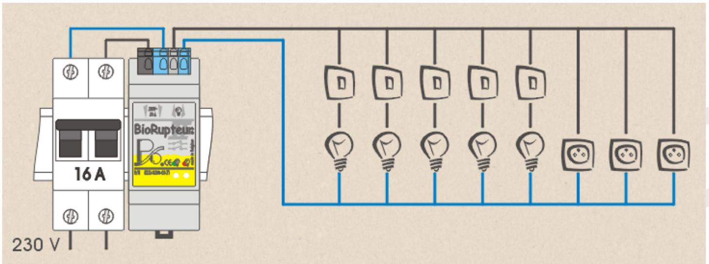
Nota : La norme française NF C15-100 impose de séparer les circuits prises des circuits d'éclairage, le schéma ci-dessus est donc uniquement un schéma de principe fourni à titre indicatif.
