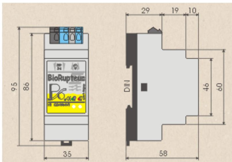
Le **Biorupteur II**® est pourvu de connexions à enfichage direct de type "Wago" afin d'assurer un branchement propre et rapide.
