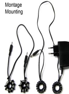
Ce kit supprime de manière fiable les interférences LF ou RF potentiellement parasites par des couplages Hautes Fréquences dans les bandes des KHz et des MHz dans les câbles connectés aux mesureurs. Utile par exemple pour le câble de connexion entre les analyseurs Hautes Fréquences et les mesureurs Basses Fréquences (NFA), ou pour les câbles DC des unités d'alimentation externes.
