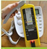
Champ électrique de basse fréquence mesuré plus de 400 mV au niveau du combiné de téléphone relié à la BOX internet.
